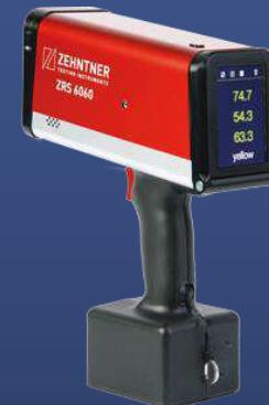
Специалисты определяют качество световозвращателей с помощью специального прибора – ретрорефлектометра.
